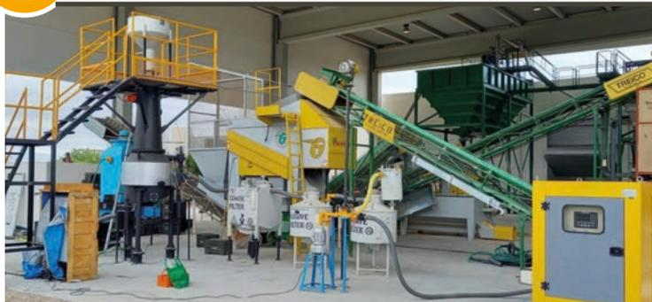
Figura 9. Planta de gasificación de 10 kW instalada en el centro IFAPA (Mengíbar, Jaén). Elaboración propia.
