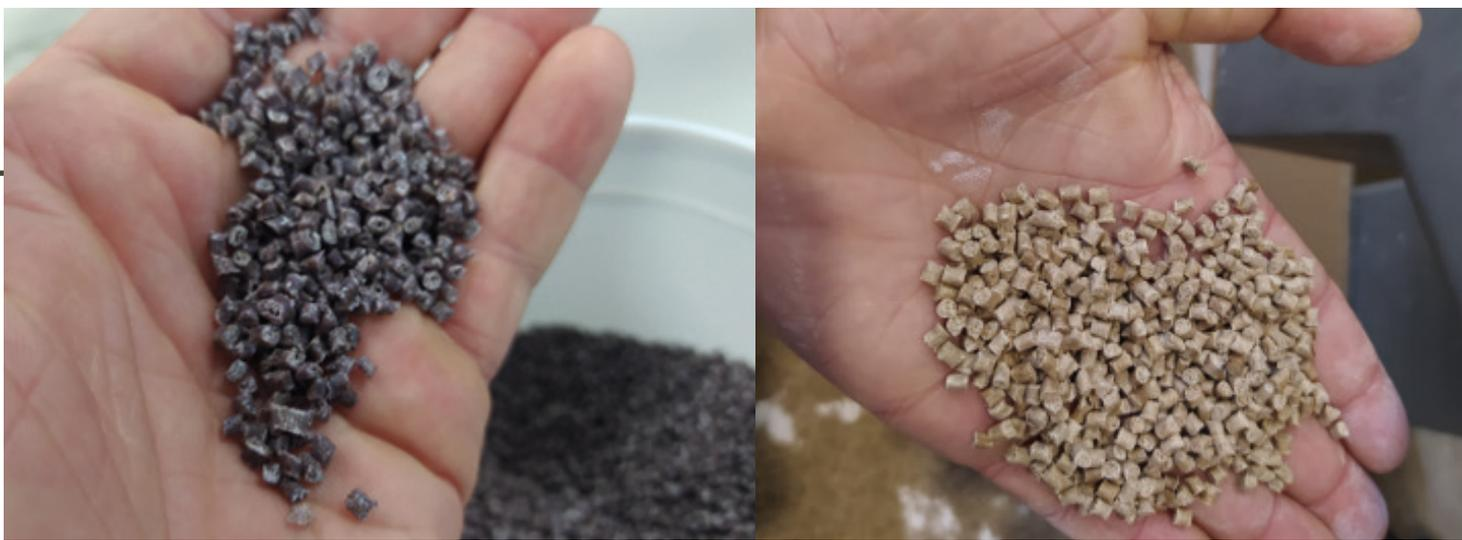
Figura 2. Pellets de material biocompuesto CompOlive: (izquierda) para Ford, (derecha) para Caliplast.
