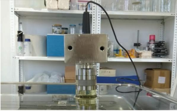
La unión de velocidad, atenuación y de frecuencia proporcionan una serie de variables ultrasónicas que caracterizan perfectamente una muestra de aceite.
